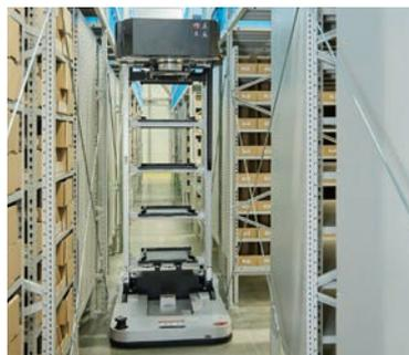
ユアサ商事株式会社様、株式会社Phoxter様とプラス ロジスティクス株式会社の3社で開発した自動搬送システム「ツインピック」。高層棚用と低層棚用2種のロボットを同時制御するユニークで革新的なシステムで、国内初事例・実用新案を取得しており、物流業務を受託している「ユアサ商事 関東物流センター」に導入しました。
