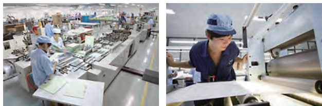
上左：フラットファイル製造ライン 上右：ラベル製造ライン 左：図面・検査基準書を掲示し、出荷製品に問題がないか厳しい目で検査します
